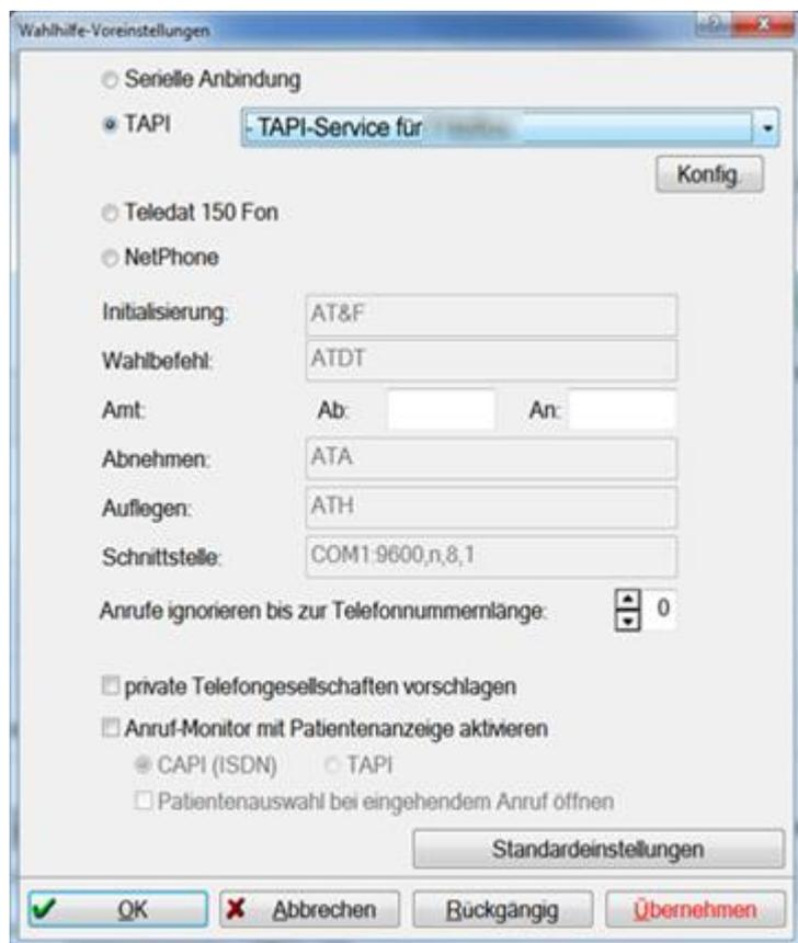
Hier muss der Punkt „TAPI“ aktiviert werden. Im rechten Auswahldialog, wählen Sie den entsprechenden TAPI-Treiber der Telefonanlage aus. Über den Button Konfiguration gelangen Sie, sofern vorhanden, in den Einstellungsdialog des TAPI-Treibers. Die Einstellungen hier entnehmen Sie bitte dem Handbuch der Telefonanlage
