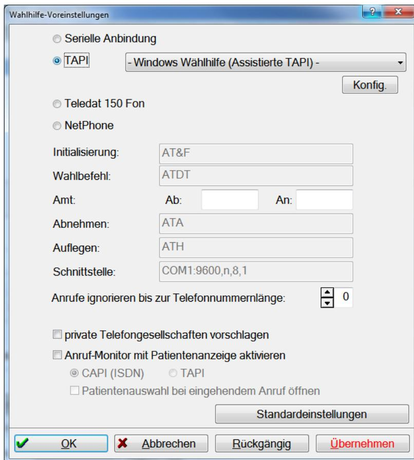
Hier muss der Punkt „TAPI“ aktiviert werden. Es öffnet sich rechts ein Auswahlfeld in welchem „Windows Wählhilfe (Assistierte TAPI)“ ausgewählt werden muss.
