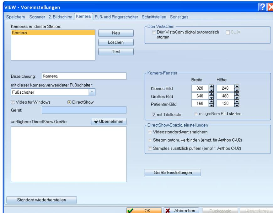
Die Kamera muss über Directshow konfiguriert sein. Außerdem ist ein mit der Kamera verwendeter Fußschalter anzugeben.
