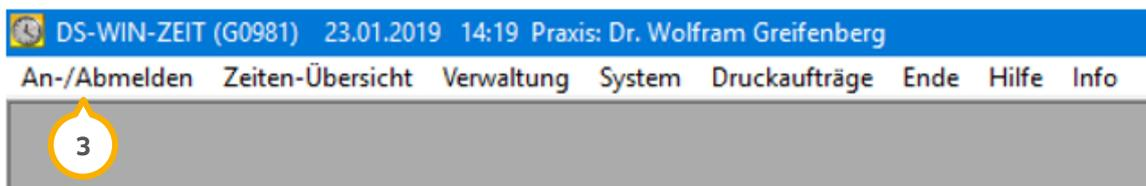
Bei Aufruf des DS-Win-Zeit und dem Versuch, Punkte im Hauptmenü anzuklicken, erfolgt zunächst die Abfrage eines Passworts. Das „An-/Abmelden“ ③ ist hiervon nicht berührt. Das voreingestellte Passwort lautet „supervisor“ und kann von Ihnen zunächst weiter verwendet werden. Wir empfehlen Ihnen jedoch, das Passwort aus Gründen der Datensicherheit anzupassen.
