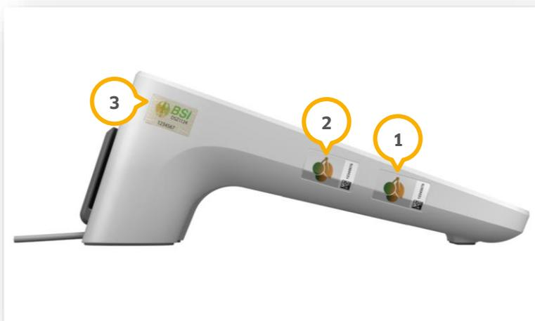
Für die gSMC-KT sind die Slots „Kontaktiereinheit 3“ ① (unten) und „Kontaktiereinheit 4“ ② (oben) vorgesehen.
